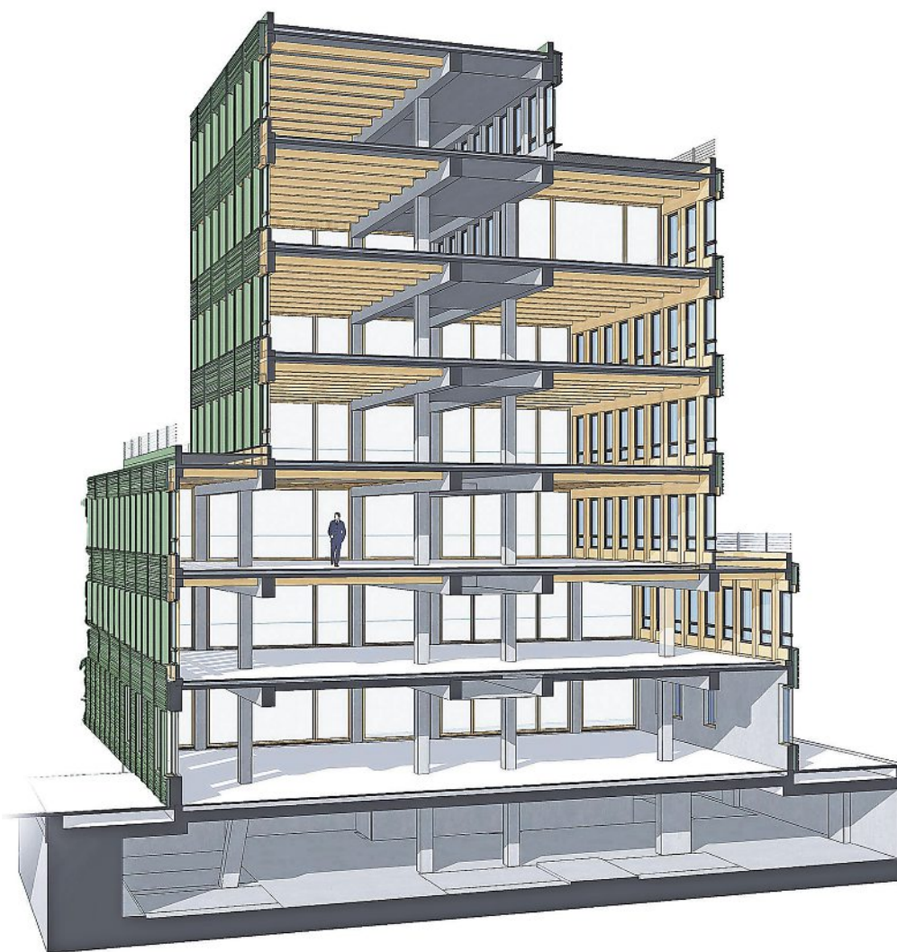
EINE HOLZ-HYBRIDBAUWEISE KOMBINIERT STAHLBETON MIT HOLZ IM TRAGWERK BEZIEHUNGSWEISE IN KONSTRUKTIVEN BAUTEILEN. FOTO: BRÜNINGHOFF
